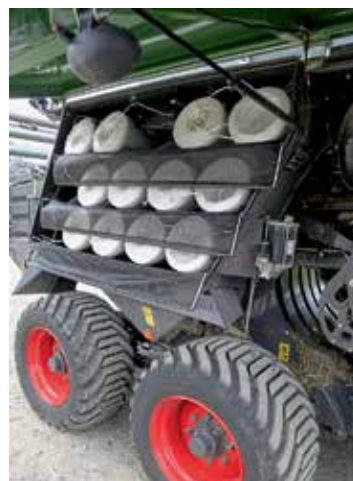
Das System mit Vorkammer hat sich bewährt. Die Einstellung der Pickup-Entlastung/-Abstützung ist noch zu verbessern. Der Kettenöler ist Serie.
