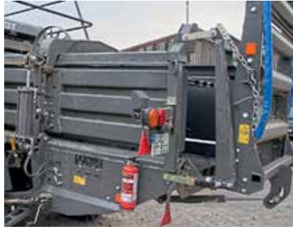
Ballenausstoßer und Rollenschurre werden hinten bedient. Die Waage ist in der Schurre integriert, die Feuchtemessung sitzt oben.
